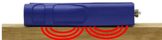
Sobald das Messgerät auf dem Prüfling angedrückt wird, erfolgt eine Veränderung des Messfeldes. Diese Veränderung wird vom Prozessor verarbeitet und ausgewertet. An der LCD-Anzeige erfolgt die Darstellung des Feuchtegehaltes in %.
