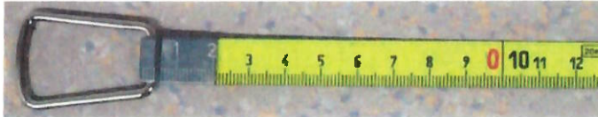
Bild 1: Beispiel (teilweise noch ohne die erforderlichen Aufschriften lt. Punkt 7.2) Stahlbandmaß 308G, Nennlänge: 20 m
