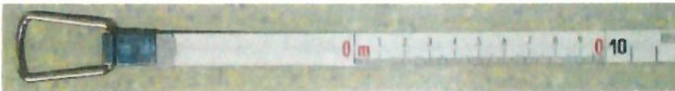
Bild 3: Beispiel (teilweise noch ohne die erforderlichen Aufschriften lt. Punkt 7.2) Stahlbandmaß 412W, Nennlänge: 100 m
