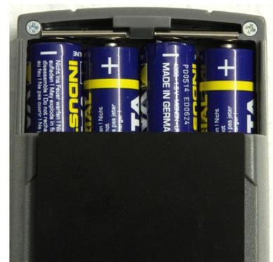
Erscheint das Batteriesymbol im Messfenster bzw. wird nach dem Einschalten ein kritischer Ladezustand angezeigt (!), sind unverzüglich die Batterien zu wechseln. Auch wenn das Gerät für längere Zeit nicht gebraucht wird, sind die Batterien aus dem Gerät zu entfernen. Für daraus resultierende Schäden gibt es keine Garantie.
