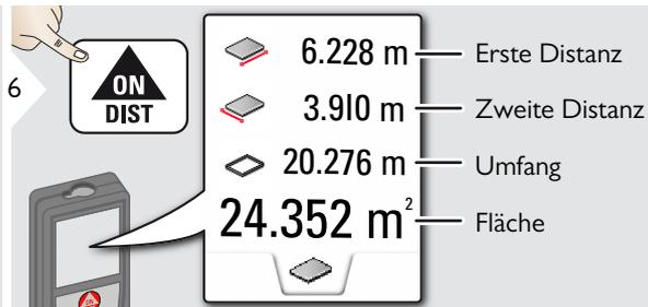
**i** Das Ergebnis wird in der Hauptzeile, der Messwert darüber angezeigt.
