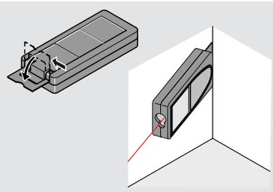
**i** Die Ausrichtung des Endstücks wird automatisch erkannt und der Nullpunkt entsprechend angepasst.
