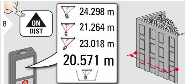
**i** Das Ergebnis wird in der Hauptzeile angezeigt. Drücken der Messtaste für 2 sec in dieser Funktion aktiviert automatisch die Minimum-/Maximum-Messung.
