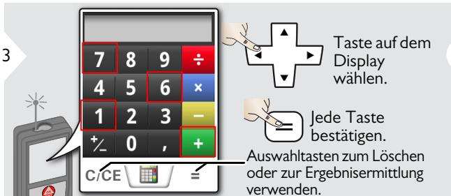
**i** Das Messergebnis aus der Hauptzeile wird in den Rechner übernommen und kann für weitere Berechnungen verwendet werden. Fuss/Zoll-Brüche werden in Fuss/Zoll-Dezimalwerte umgerechnet.
