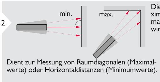
Die gemessene Minimum- und Maximumdistanz wird angezeigt (min, max). Der zuletzt gemessene Wert wird in der Hauptzeile angezeigt.
