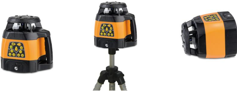
Direkt nach dem Einschalten beginnt das Gerät, sich selbst zu nivellieren (Laserpunkt blinkt). Wenn der Selbstnivellierungsvorgang abgeschlossen ist, beginnt sich der Rotorkopf zu drehen. Wenn keine Selbstjustage erfolgt, wurde das Gerät außerhalb des Selbstnivellierungsbereiches aufgestellt. Gerät auf eine waagrechtere Ebene stellen.
