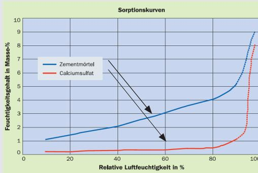
in der Regel von der Temperatur nur wenig ab und nehmen einen leicht anderen Verlauf, wenn eine Probe Wasser abgibt, also trocknet, oder wenn sie Wasser aufnimmt. Man spricht bei der Wasserabgabe von Desorption, daher **Desorptionsisotherme**, und bei der Wasseraufnahme von Adsorption, also **Adsorptionsisotherme**. Die Abweichung zwischen den Gleichgewichtswerten während der Wasseraufnahme und der Wasserabgabe bezeichnet man als **Hysterese**.
