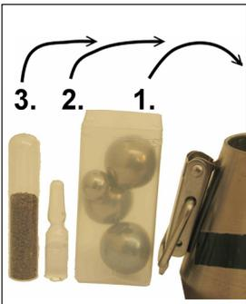
Durch Schütteln des CM-Gerätes werden die Ampullen zertrümmert und die freigesetzten Reagenzien können miteinander reagieren. **Die Reaktion ist in der Regel nach 2 bis 3 Minuten abgeschlossen und der Enddruck muss bei 1.00 bar  $\pm$  0.05 bar liegen.**
