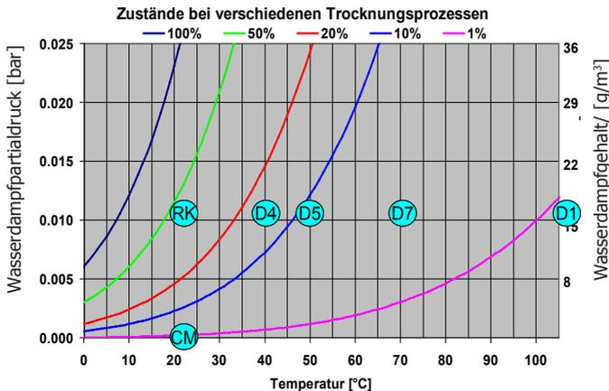
Neben der Ofentrocknung auch Darrung oder Trockenschrankmethode genannt, kommen in der Praxis auch weitere **direkte Methoden zur Bestimmung des Wassergehaltes** zur Anwendung, denen gemeinsam ist, dass einer Probe das Wasser durch Lagerung in einer Umgebung mit geringer relativer Luftfeuchtigkeit (z.B. Gefriertrocknung, Trocknung im Exsikkator) Wasser entzogen wird.
