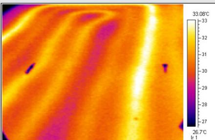
Nebenstehendes Bild zeigt die Infrarotaufnahme einer beheizten Estrichflächen. Die hellen Linien zeigen deutlich den Verlauf der Heizschlaufen. Es muss davon ausgegangen werden, dass die Bereiche bei den Leitungen trockener sind, als die Bereiche zwischen den Leitungen.
