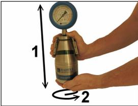
5 Danach führt man während einer Minute kreisende Bewegungen durch, um das Reaktionsgemisch miteinander zu vermischen. Bei flüssigen oder pastösen Proben empfiehlt es sich, die Druckflasche flach zu halten und mehrmals um die eigene Längsachse zudrehen (siehe unteres Bild). So kann auch an der Innenwand anhaftendes Probenmaterial zur Reaktion gebracht werden. Diesen Vorgang wiederholt man nach ca. 3 Minuten nochmals.
