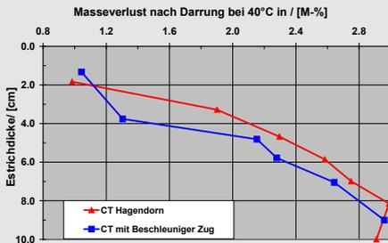
Die nebenstehende Grafik zeigt für zwei verschiedene zementäre Estrichsysteme das Feuchtigkeitsprofil. Das freie Wasser wurde mittels Darrung bei 40°C bestimmt. Es kann aber ebenso durch eine CM-Messung ermittelt werden.
