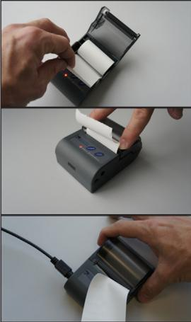
Die transparente Abdeckung ist dann aufzuklappen und die leere Hülse zu entfernen. Die neue Papierrolle ist etwas abzurollen und entsprechend dem nebenstehenden Bild einzulegen. Dabei ist zu achten, dass das Papier gerade eingelegt ist.
