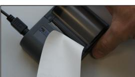
Das ausgedruckte Protokoll kann durch schräges Abreißen von der Rolle gelöst werden. Die andere Hand hält dabei den Drucker fest. (Bild 8).
