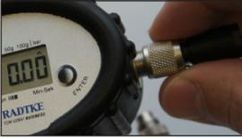
Bei eingeschaltetem Manometer ist die **Kabelabdeckung zu entfernen** (Bild 1).
