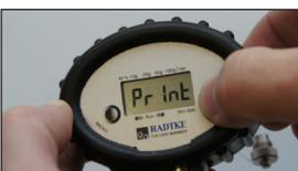
Beim Manometer wird durch dreimaliges Drücken der Menu Taste der Druckbefehl PrInt angewählt und innerhalb von 7 Sekunden mit der Enter Taste bestätigt (Bilder 5 und 6).
