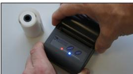
Um die Papierrolle zu wechseln muss der Drucker nicht eingeschaltet sein. Ist die Papierrolle leer, blinken beide LED gleichzeitig in schneller Wiederholung. Um die Papierrolle auszutauschen muss zuerst die transparente Kunststoffabdeckung geöffnet werden. Diese ist dazu zwischen dem Daumen und Zeigefinger seitlich zusammenzudrücken und anzuheben. Die andere Hand hält den Drucker dabei fest.
