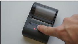
**STANDBY:** Erfolgt nach dem letzten Ausdruck oder nach dem Einschalten des Druckers während zwei Minuten kein Tastendruck oder wird kein Protokoll ausgedruckt, so stellt sich der Drucker automatisch in den standby Modus um Strom zu sparen. Bei ursprünglich vollem Akku kann er so noch während bis zu 14 Tagen eingesetzt werden.
