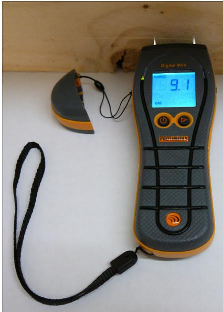
**Feuchtemessgerät PROTIMETER DigitalMini**
