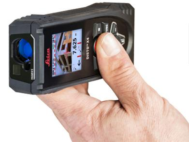
Die Kamera mit mit Zielsucher ermöglicht es Ihnen, mit dem Leica DISTO™ X4 bei starkem Sonnenlicht auf weit entfernte Objekte exakt zu zielen und diese zu messen – das Zielobjekt ist klar und deutlich auf dem hochauflösenden Bildschirm des „X4“ zu sehen. Der DISTO™ X4 ist speziell dafür konzipiert, hochpräzise Outdoot-Messungen zur einfachsten Aufgabe der Welt zu machen.
