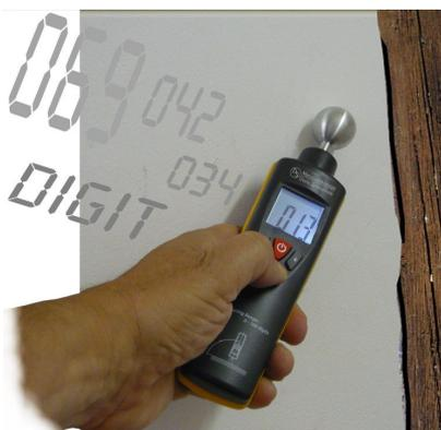
**zerstörungsfreies Bau-Material-Feuchtemessgerät BMF40**
