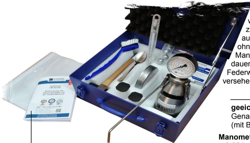
Koffer mit Messgerät zur Schnellbestimmung der Restfeuchtigkeit von Unterlagsböden. Arbeitet nach der bewährten Carbid-Methode (CM). Der Koffer ist mit allen zur Bestimmung notwendigen Werkzeugen & Chemikalien ausgerüstet. Die Feuchtigkeit kann auf dem Manometer ohne Umrechnungstabelle direkt abgelesen werden. Der Manometer hat eine Drosselschraube, wodurch die Lebensdauer wesentlich verlängert wird. Die robuste mechanische Federwaage ist mit einer Ablesehilfe aller gängigen Einwaagen versehen.
