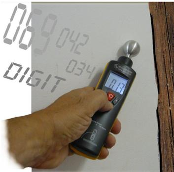
**zerstörungsfreies Bau-Material-Feuchtemessgerät BMF40**
