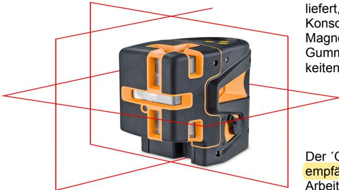
Der 'Geo5X-L360 HP' wird mit einer multifunktionalen Halterung ausgeliefert, die das Messen vereinfacht. Sie besteht aus einer höhenverstellbaren Konsole, auf der das Gerät in jeder Position fixiert werden kann. Durch Magnete kann das Gerät an magnetischen Oberflächen angebracht werden - Gummipoppen verhindern das Verrutschen. Weitere Anbringungsmöglichkeiten bestehen durch Schraubenaufhängung und die Riemenbefestigung.
