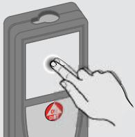
Auf das Display tippen, um eine Schaltfläche auf dem Bildschirm zu öffnen oder eine Auswahl zu treffen. Das Antippen des Symbols in der Mitte der untersten Zeile aktiviert die Distanzmessung oder löst die Kamera aus.
